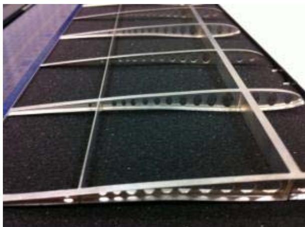
図7 軽量主翼桁構造の試作
