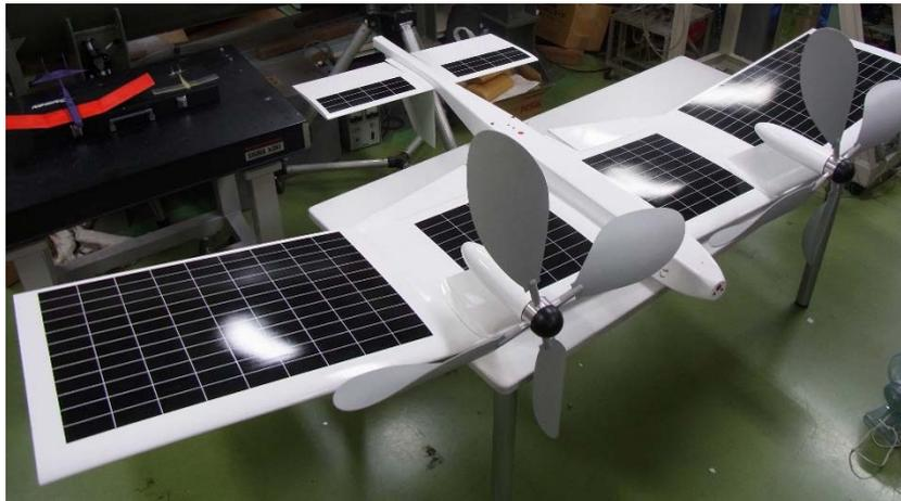
図11 試作された火星飛行機のモックアップ
