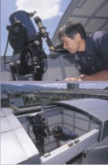
熊本教育学部屋上に設置されているインターネット天文台。開閉式の屋根を備え、全てがオンラインで操作できるようにになっている。
