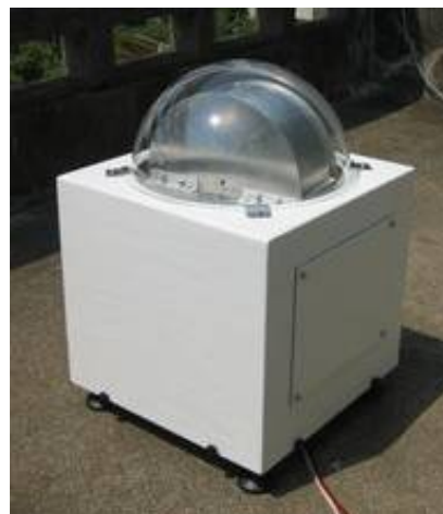
図7：完成した星座カメラ i-CAN の内部構造（左）と外観（右）。ステッピングモーター駆動によるカメラのチルト&パン機構、それらコントロールと映像エンコーディングを行う PC、すべてが一辺 35cm 余りの箱の中に収められている。外側の白色塗装は遮熱性を持つ塗料で、日中の内部温度上昇を軽減している。
